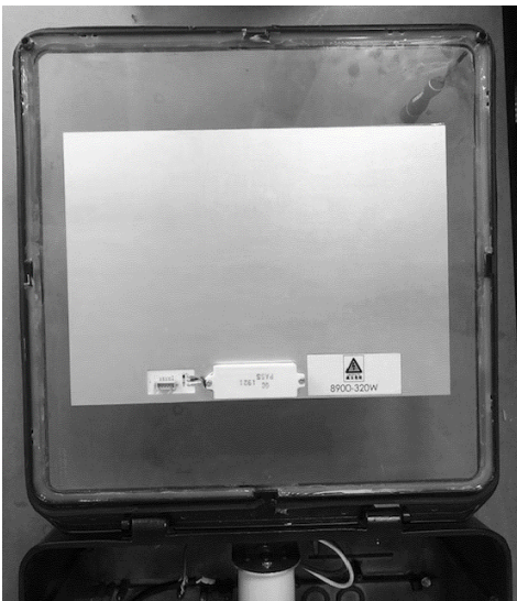
Figura 3 - Panel LED adherido al interior de la lente de vidrio
